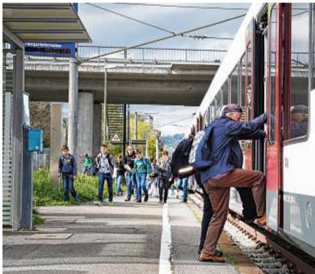
Die Bahnsteige am Haltepunkt Böhringen-Rickelshausen sind extrem niedrig. Der Ein- und Ausstieg der Waggons ist hingegen sehr hoch. Die Deutsche Bahn hat, anders als vorher geplant, verlauten lassen: Sie saniert den Bahnsteig erst Ende 2018. BILD: GERALD JARAUSCH
